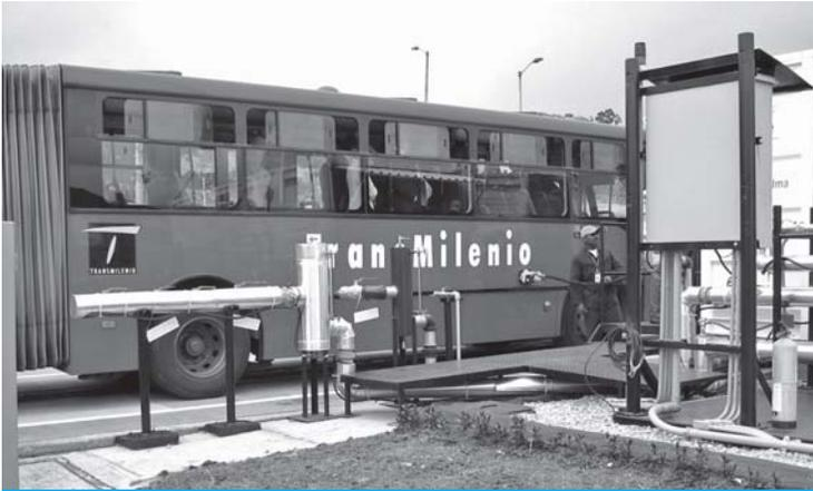
Entre 2007 y 2008 se realizaron las primeras pruebas de larga duración utilizando buses del operador Sí99 del sistema Transmilenio en Bogotá; se recorrieron un millón de kilómetros y se consumieron 41.512 galones de biodiésel.
