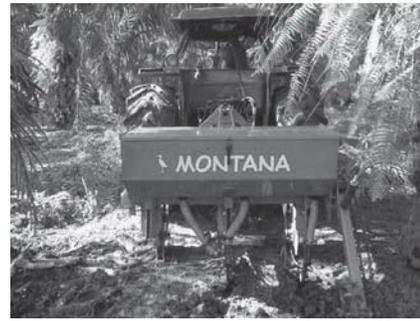
**Figura 3.** Renovador de praderas en incorporación de fertilizantes.
