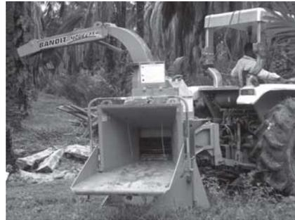
**Figura 4.** *Chipper Bandit 150* en triturado de estípites.
