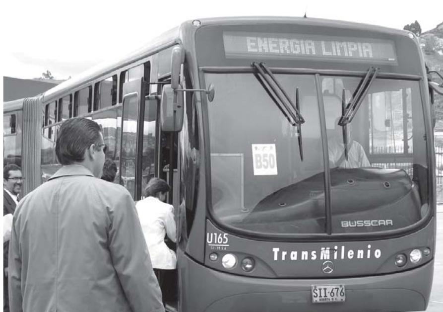
Luego de recorrer más de un millón de kilómetros con las mezclas diesel-biodiésel de palma en los buses de Transmilenio, se confirmó el efecto positivo del biodiésel en el comportamiento del motor y en el medio ambiente.
