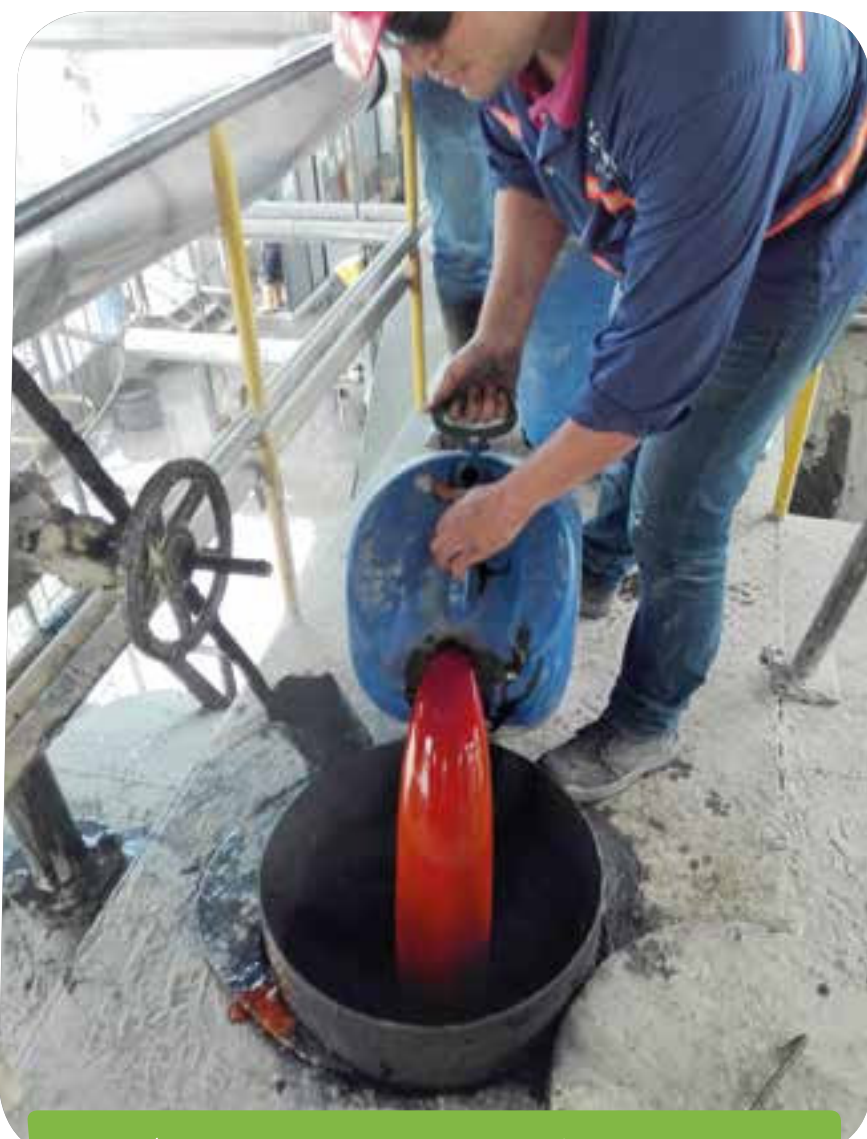
Adición de aceite crudo de palma a asfalto
