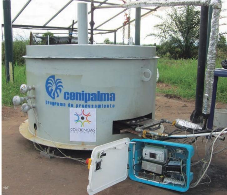
Reactor de pirólisis con sistema de control automatizado para seguimiento de variables de proceso.
