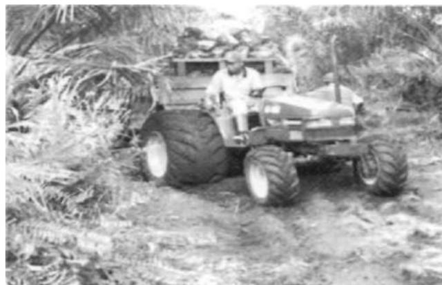
**Figura 9** Uso de llantas de flotación en turba profunda
