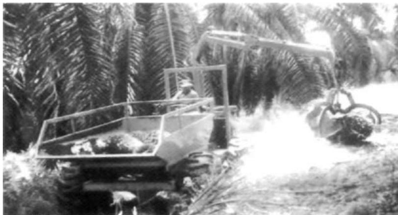
**Figura 4** Máquina de grúa con garra para recolección en campo fabricada localmente
