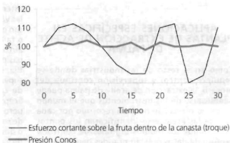
Figura 1. Torque - presión conos vs. tiempo.
