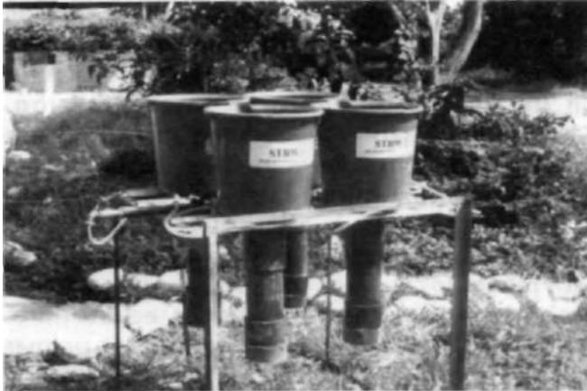
Figura 4. STRW Sato Root Wash, un separador hidráulico de raíz.
