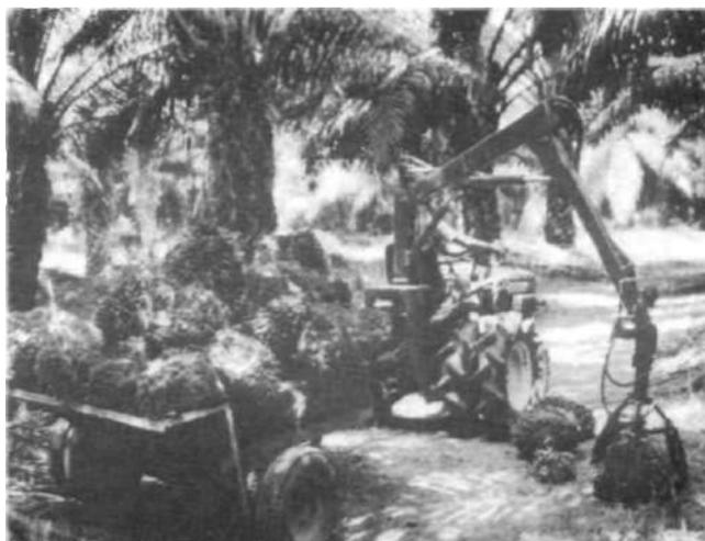
Figura 4. Minitractor con el "Grabber" (cargue mecánico).
