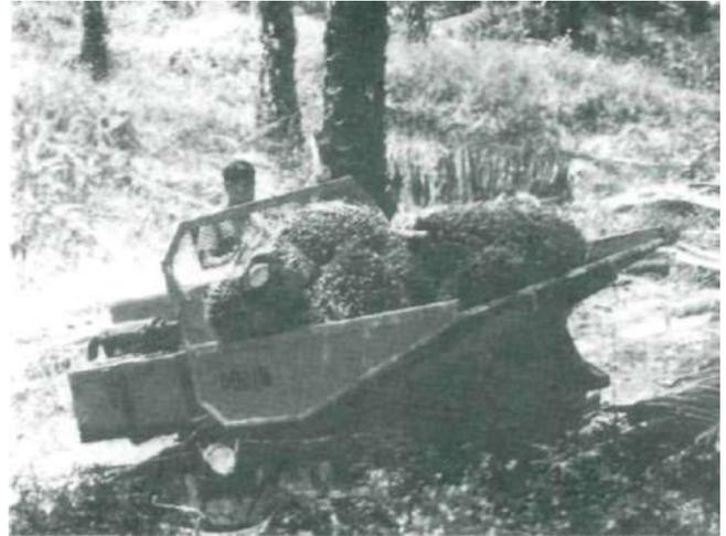
Figura 9. El "Super - Crawler", efectivo en áreas blandas onduladas.
