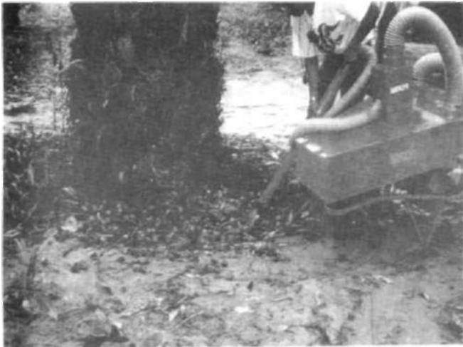
Figura 14. Colector mecánico de fruto suelto (Tipo "Push-Gart").
