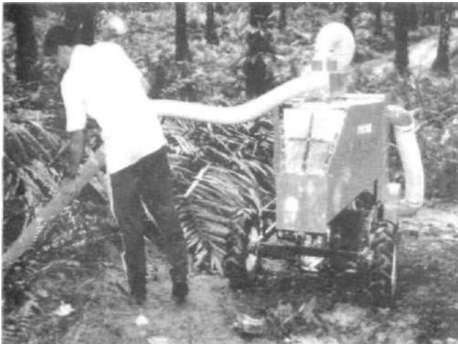
Figura 15. Colector mecánico de fruto suelto (Autopropulsado).
