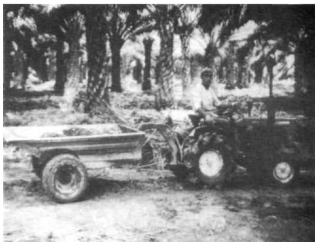
Figura 3. Minitractor con remolque (cargue manual de los RFF).
