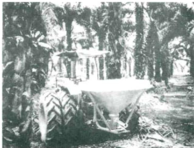
Figura 20. Aplicador mecánico de fertilizante tipo péndulo.
