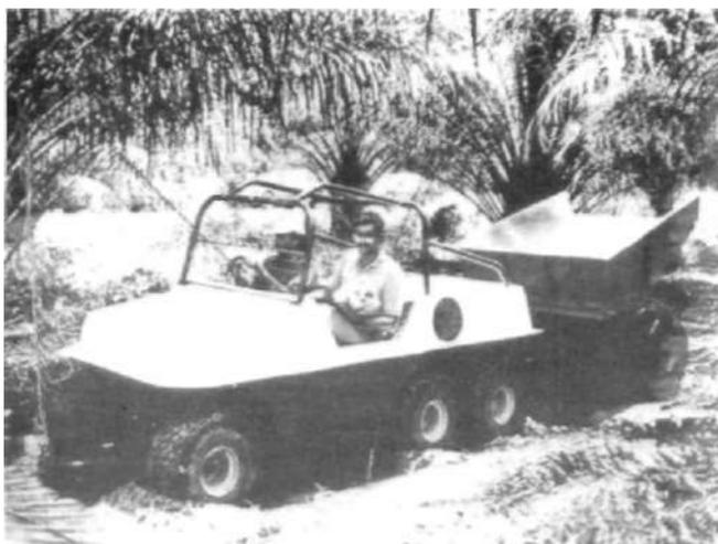
Figura 11. El "Teltrac" acondicionado con llantas de baja presión al suelo (LGP), adaptado para áreas de turba.
