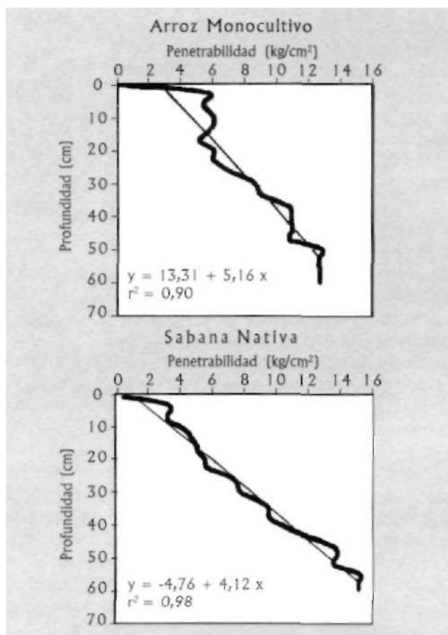
Figura 1. Resistencia a la penetración bajo condición de arroz monocultivo en comparación con sabana. Ensayo Culticore-Carimagua/9.
