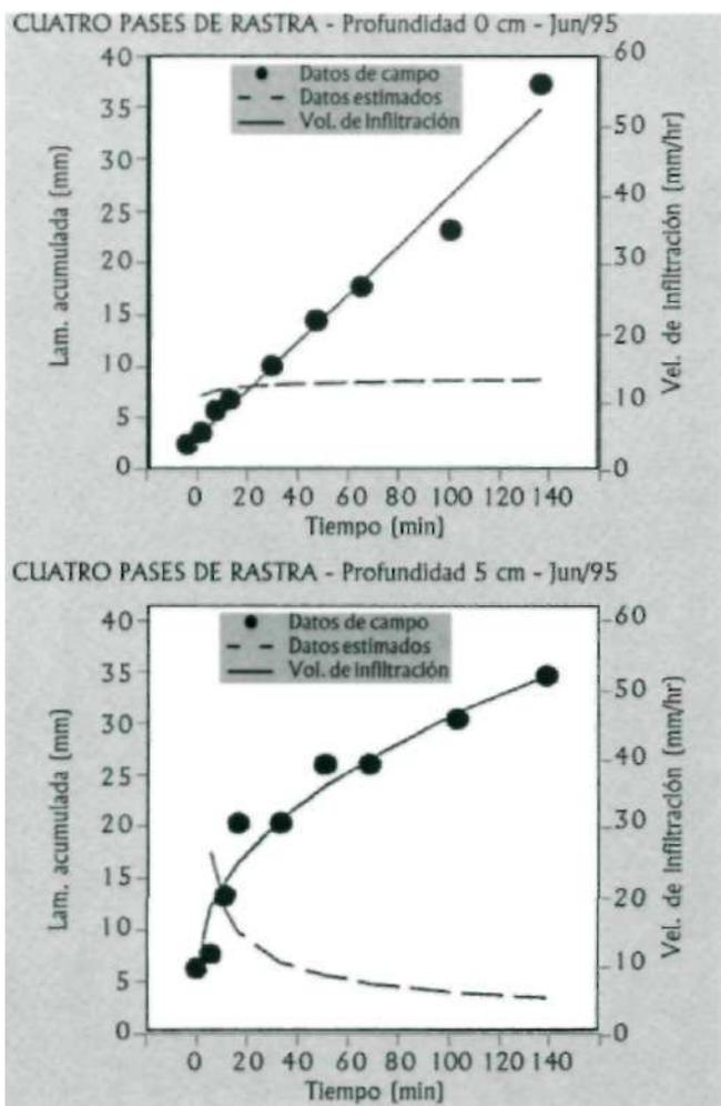
Figura 4. Infiltración acumulada y velocidad de infiltración en ensayo de labranza en Matazul
