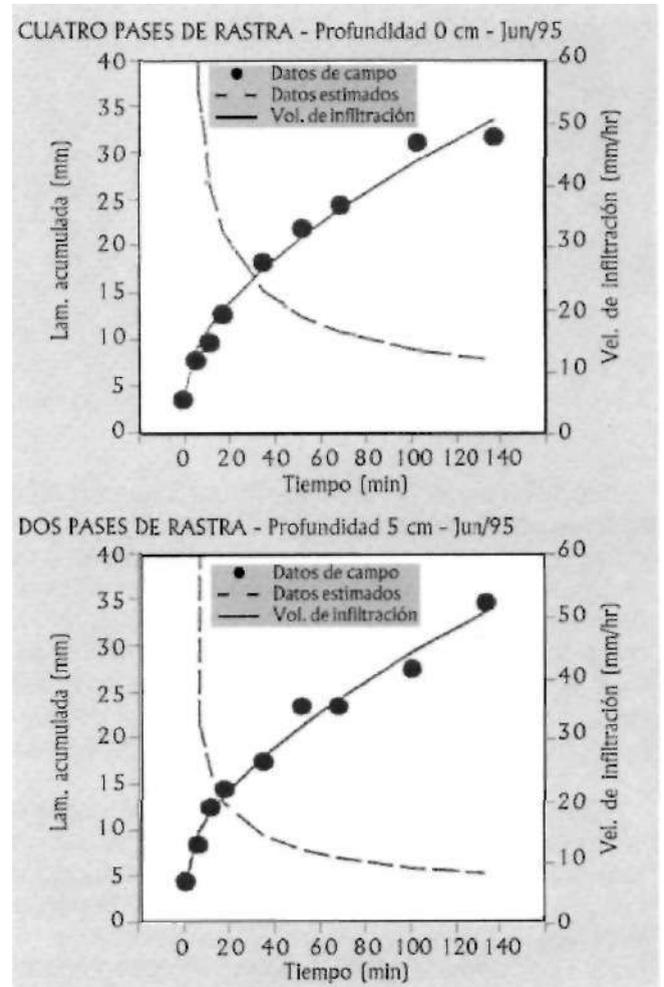
Figura 3. Infiltración acumulada y velocidad de infiltración en ensayos de Matazul
