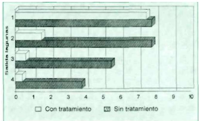
Figura 3. Valores de la DBO en un sistema de lagunas
