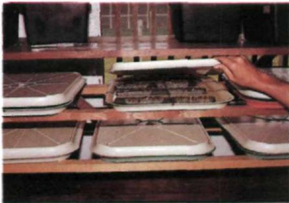
Figura 3. Trampa de White para coleccionar nematodos.
