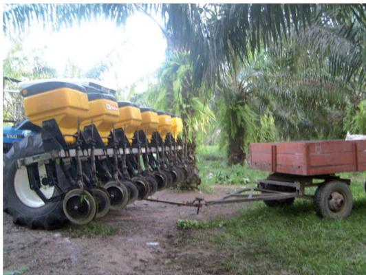
Figura 5. Barra de tiro de 2 m de longitud para el tiro del transporte de fertilizante.
