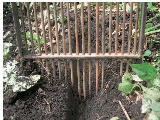
Figura 3. Medición de perfil de corte en campo.
