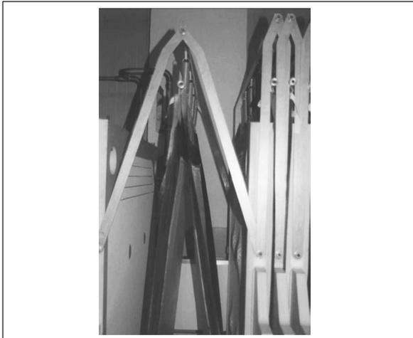
Figura 12. Sistema de descarga de torta.
