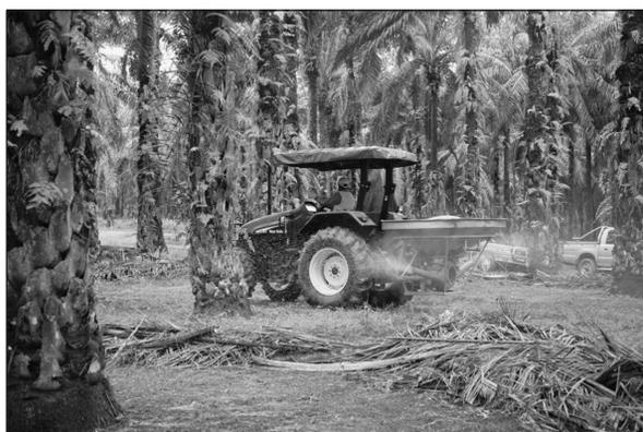
**Figura 9.** Sistema MBS. Tractor asperjando el fertilizante entre surcos.
