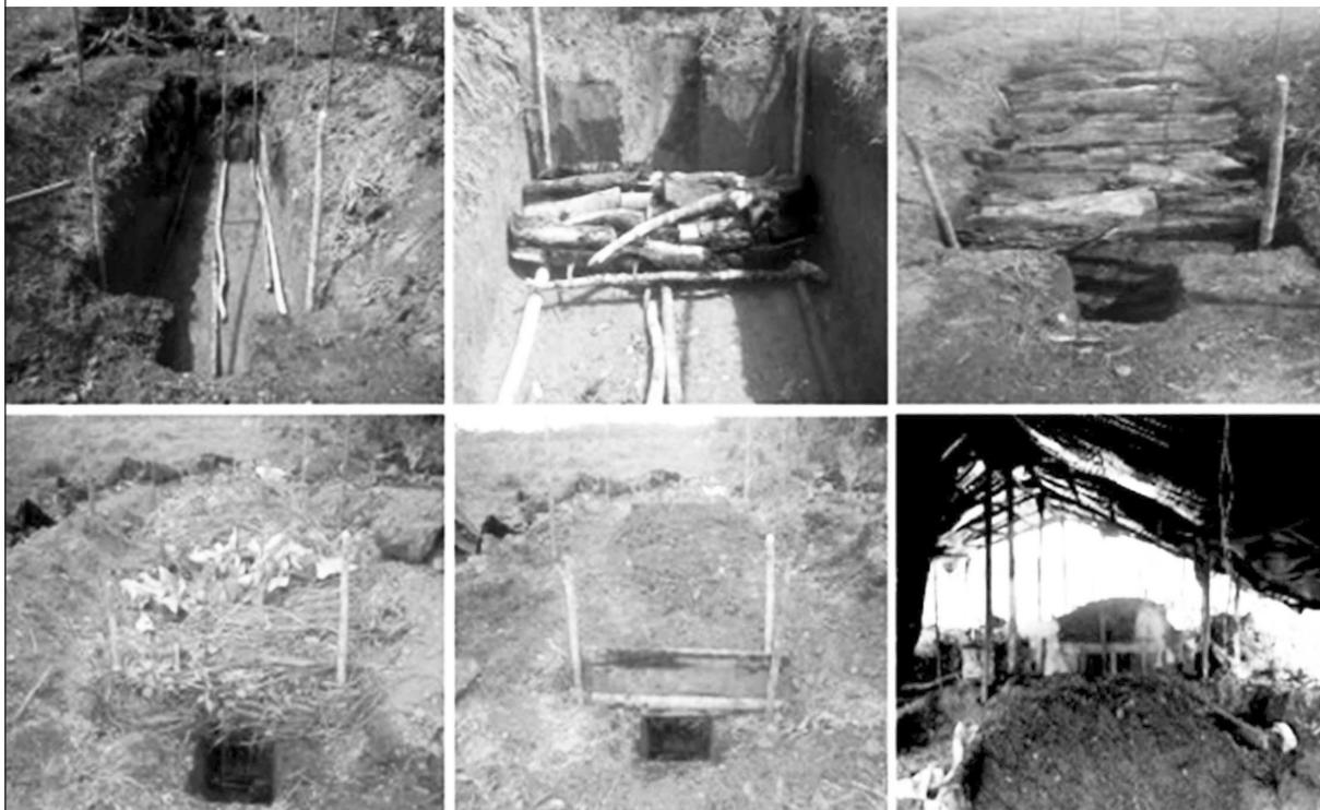
Figura 8. Generación del biocarbón utilizando el método de la fosa.
