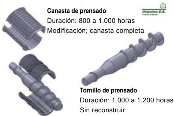
**Figura 10.** Vida útil de la canasta de prensado y el tornillo de prensado.
