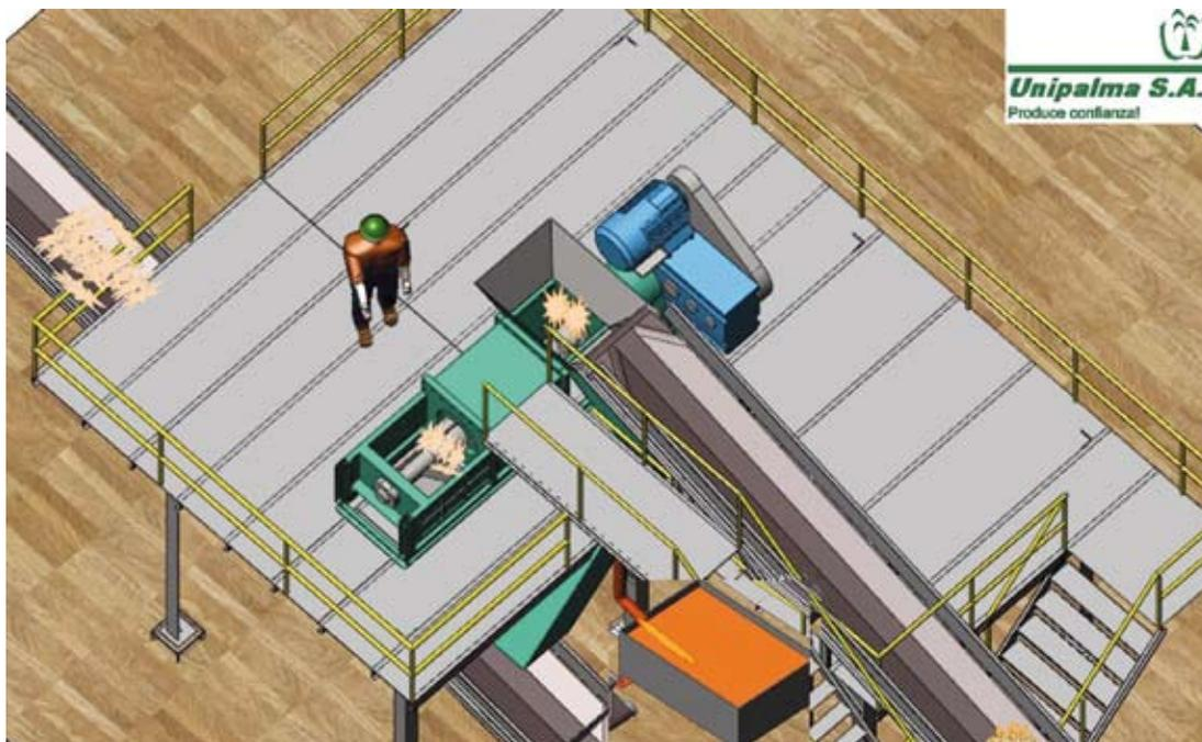
Figura 2. Esquema del montaje de la prensa de tusa en la planta.
