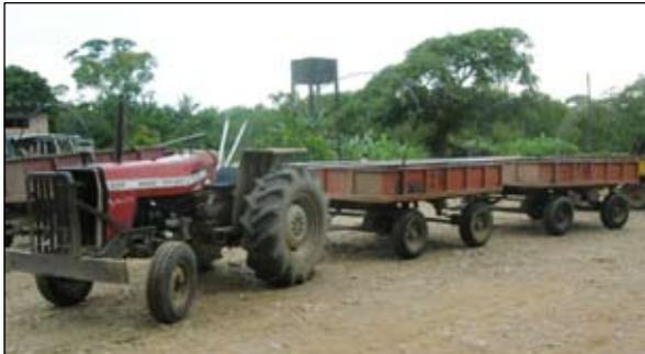
**Figura 4.** Sistema de transporte con tractor remolque sin alce hidráulico TRS.
