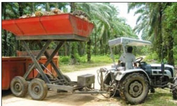
**Figura 3.** Sistema de transporte con tractor remolque de llanta convencional TRLLC.
