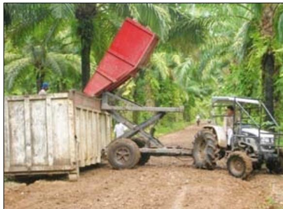
**Figura 1.** Sistema de transporte con tractor remolque con llanta de avión TRLLA
