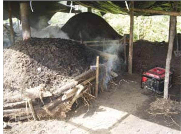
**Figura 4.** Ignición de la pila aérea de carbonización. Fuente: autores (2008).
