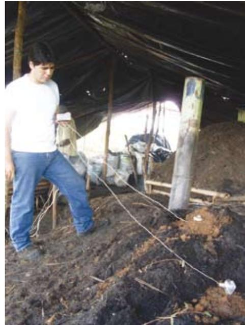
**Figura 7.** Rotación de termocuplas sobre la base hexagonal de pila de carbonización. Fuente: autores (2008).
