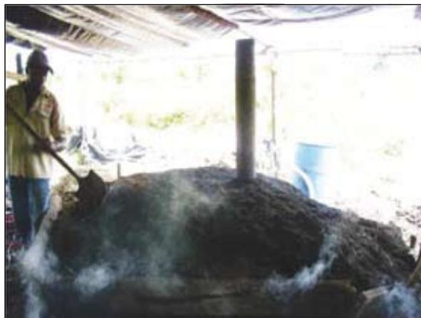
**Figura 9.** Pila de carbonización próxima a la etapa final del proceso termoquímico. Fuente: autores (2008).
