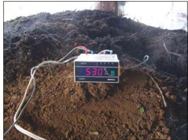
**Figura 8.** Lector digital de temperaturas internas en la pila de carbonización. Fuente: autores (2008).
