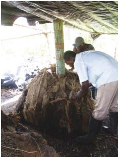
**Figura 3.** Montaje de la pila aérea de carbonización de estípites de palma. Fuente: autores (2008).
