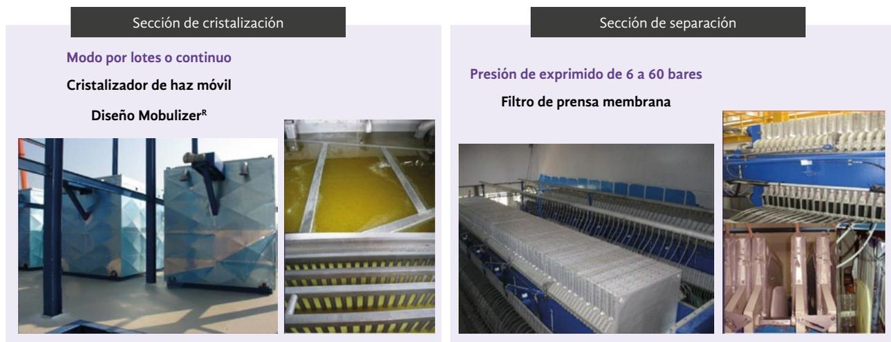
En la Figura 8 tenemos una operación de un cristallizador que funciona de manera continua: el Iconfrac, desarrollado por Desmet. El aceite fusionado es vaciado en una masa que ya está cristalizada y es bombeada sin interrupción, ya sea a un segundo cristallizador o directamente al filtro de prensa membrana.
