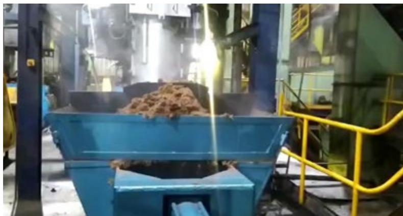
La posibilidad de disminuir el rompimiento de nueces es muy favorable para el *guineensis*, al igual que la estabilidad en las pérdidas en fibras, el mejoramiento de la separación de nueces en las columnas y la optimización de la combustión de la caldera (Figura 2). Para el equipo, que se monta entre el digestor y la prensa, en lugar de ser un ducto o un cajón de lámina, internamente reemplazamos ese ducto y montamos un equipo adicional, el cual tiene componentes mecánicos y eléctricos.
