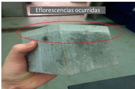
Los especímenes con polvo de piedra caliza pueden causar precipitación adicional debido a la reacción de  $\text{Ca}(\text{OH})_2$  en la matriz de hormigón con las puzolanas (POFA) para formar geles de C-S-H y, por lo tanto, aumentar la densidad del hormigón mientras se empuja el exceso de  $\text{CaCO}_3$  insoluble a través de los capilares del mismo. Como los especímenes con polvo de piedra caliza experimentaron dos fases
