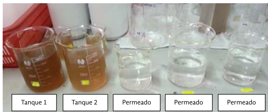
Figura 9. Visualización de muestras de agua del tanque 1, tanque 2 y permeado (de izquierda a derecha)
