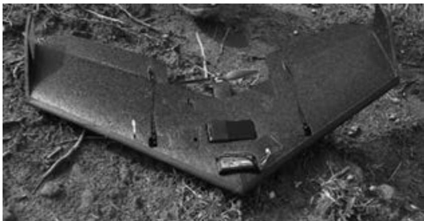
**Figura 3.** Swinglet con cámara compacta modificada.
