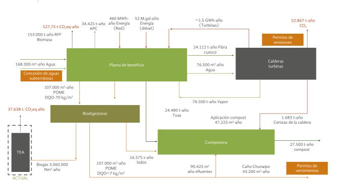
Figura 1. Diagrama de balance de emisiones de proceso de extracción de aceite de palma crudo
