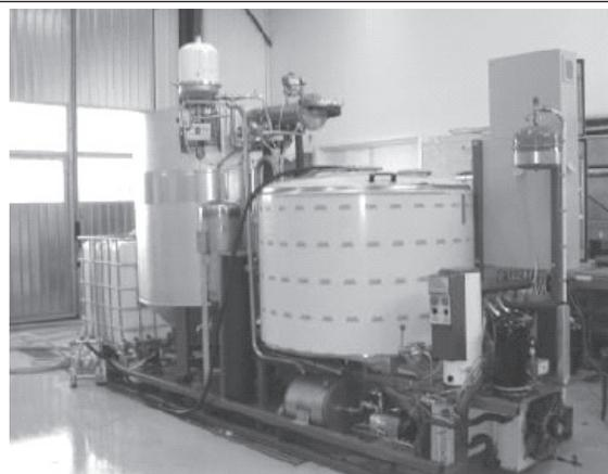
**Figura 7.** Instalación pequeña planta de Biodiésel.
