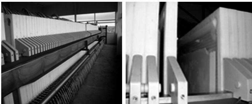
**Figura 3.** Vista de un filtro prensa de membrana (membrana externa/placas).
