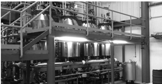
**Figura 7.** Planta industrial de interesterificación enzimática (40t/día).
