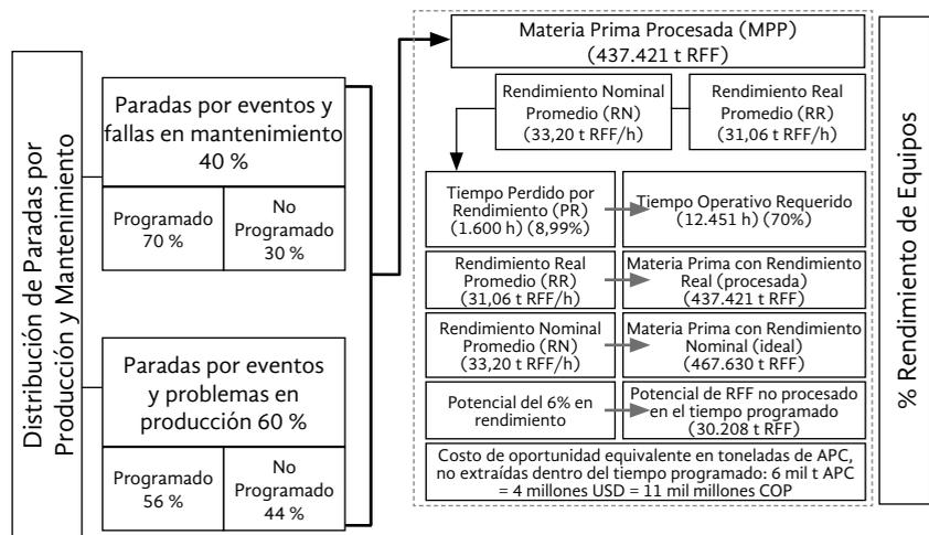
Teniendo en cuenta el tiempo total calendario de operación de 18.773 horas para las plantas piloto analizadas (Figura 8), 21 % de este tiempo contiene los principales problemas identificados como críticos, entre los cuales sobresalen las paradas frecuentes por mantenimiento programado (28 %) y falta de RFF para proceso (11 %). Debido a los problemas identi-
