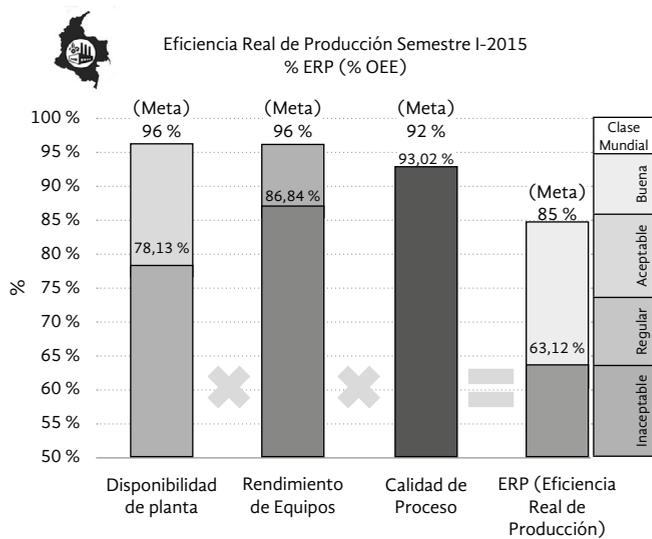
**Figura 5.** Diagnóstico de eficiencia mediante indicador ERP en plantas piloto de las zonas Norte, Central y Oriental, en 2015.
