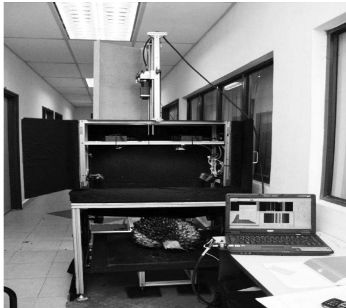
Figura 3. Vista esquemática del sistema de imágenes hiperespectrales con un racimo de fruta fresca en la cinta transportadora. (Tomado de O.M. Bensaheed et al. Clasificación de fruta de palma mediante un dispositivo hiperespectral y algoritmos de aprendizaje automático. Series de Conferencias IOP: Ciencias de la Tierra y Ambientales 20, 2014, 012017).
