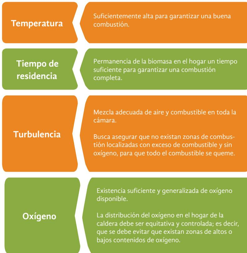
**Figura 3.** Variables primarias a controlar en el proceso de combustión
