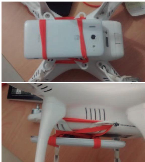
**Figura 5.** Adaptación realizada al *Phantom 2* para toma de fotografías aéreas.
