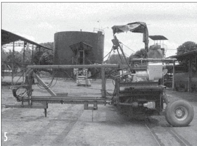
**Figuras 4,5** Equipo utilizado para volteo de la fibra de racimos vacíos, obsérvese el detalle del sistema de bombeo ubicado a un costado del equipo
