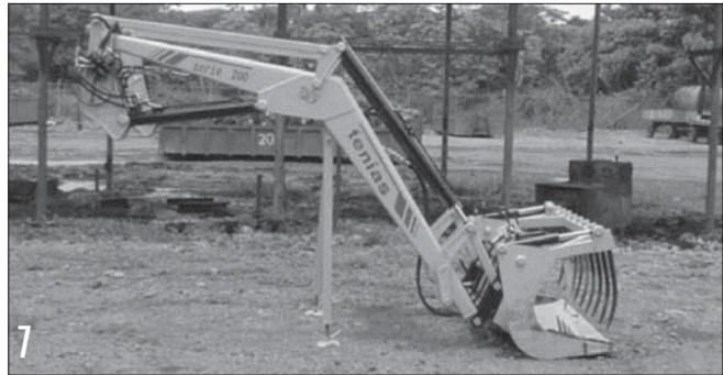
**Figuras 6,7** Arriba, tractor de 130 HP utilizado para operar los equipos de compostaje en plena labor. Abajo, pala hidráulica utilizada junto con el tractor para reacomodar fibra y compost en el patio
