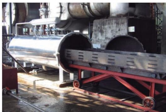
Figura 1. Esterilizador a escala.
