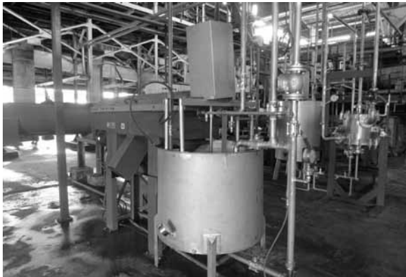
Figura 3. Sistema de clarificación a escala experimental para el aceite de palma con base en la evaporación.
