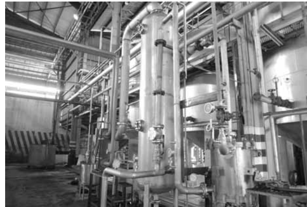
Figura 4. Sistema de clarificación a escala experimental para el aceite de palma con base en la evaporación.
