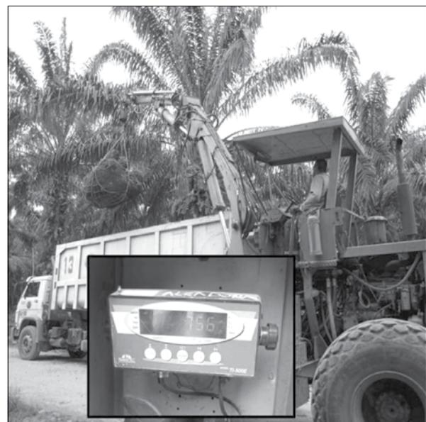
**Figura 7.** Pesaje mecanizado de RFF.
