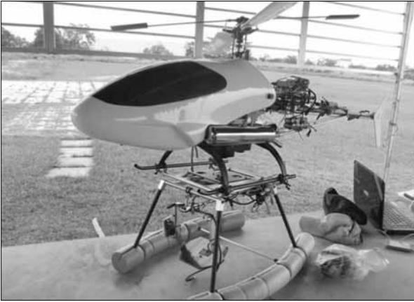
**Figura 17.** UAV con motor a gasolina de 23 cc equipado con piloto automático.
