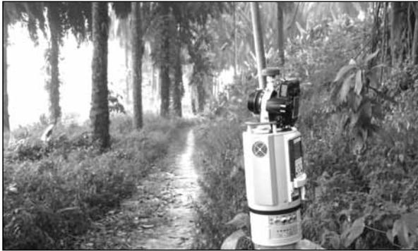
**Figura 24.** Escáner Láser 3D utilizado en una plantación de palma de aceite.
