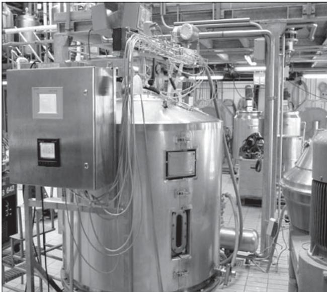
**Figura 5** Reactor Plug&Play con 400 kg de enzima
