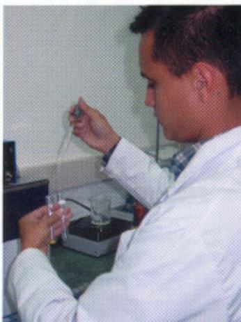
Una parte de los extractos obtenidos por lixiviación se llevó al Laboratorio de Caracterización de Aceites de Cenipalma, se disolvió en cloroformo y se analizó por cromatografía líquida de alta eficiencia, (HPLC) determinando la relación de los isómeros  $\alpha$  y  $\beta$ . Para esto se utilizó un equipo Merck Hitachi con un detector UV-Vis. y una columna Chromolith RP-18e y como estándar  $\beta$ -caroteno al 95% (Sigma).
