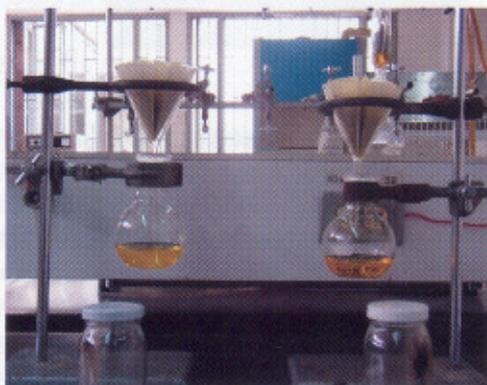
Filtración de los extractos de carotenos obtenidos a partir de la fibra prensada de palma.
