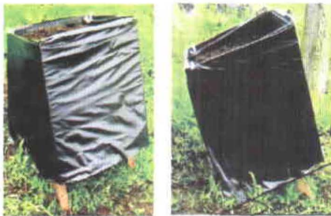
Figura 1. Estructura básica del rizotróon. El rizotróon es rodeado por bolsas oscuras para evitar la penetración de la luz que pudiera interferir con el crecimiento de las raíces. Para asegurar el crecimiento de las raíces hacia la cara de calcado, el rizotróon es inclinado 30° hacia esta cara.
