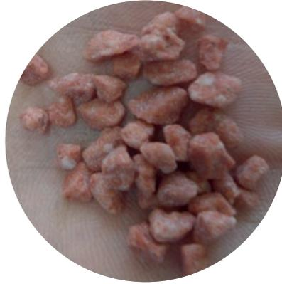
**Figura 40.** Aspecto del cloruro de potasio (KCl) granular (60 % de  $K_2O$ ).
