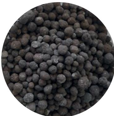
**Figura 39.** Aspecto del superfosfato triple (46 % de  $P_2O_5$ ).
