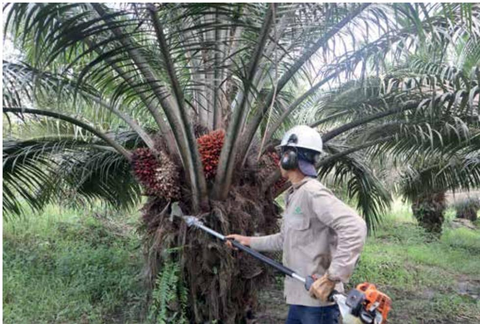
**Figura 1.** Corte de RFF realizado con cortadores mecanizados. Foto: Teatín, 2022.
