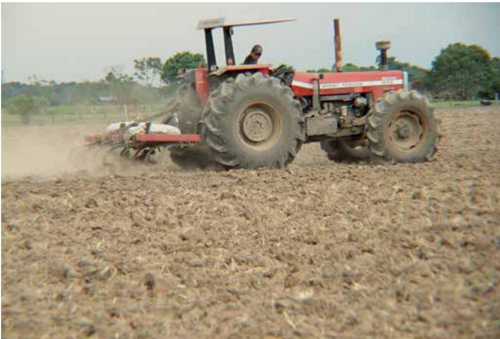
**Figura 1.** Cincelado del suelo implementado dentro de las labores de adecuación de suelos. Foto: Toro, F.
