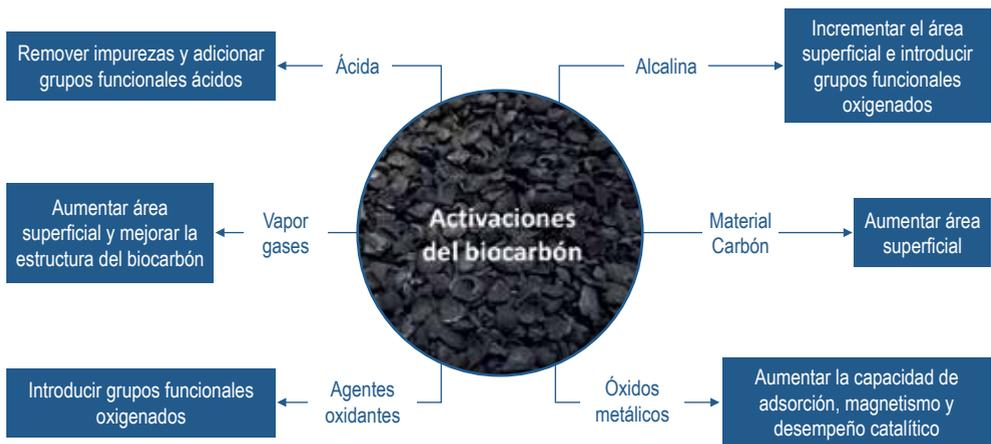
Figura 9. Métodos de activación del biocarbón.
