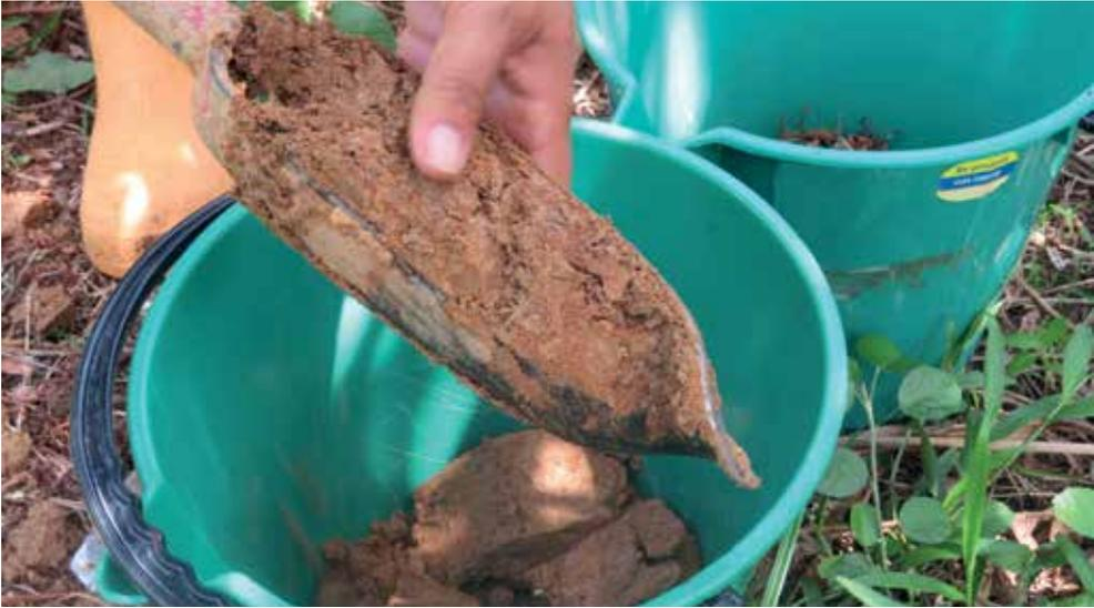
Figura 12. Depósito de la muestra con barreno en balde.
