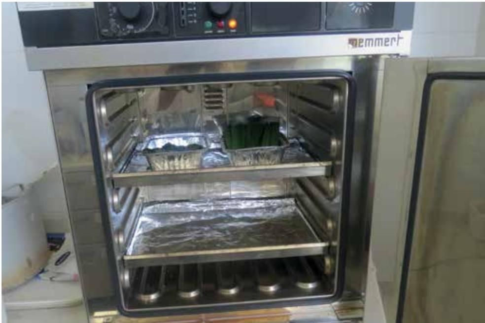
Figura 62. Horno para secado y disposición de las muestras.
