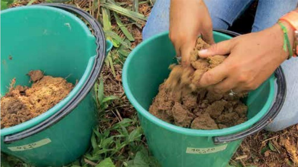
Figura 24. Homogenización de muestra, capa superficial.
