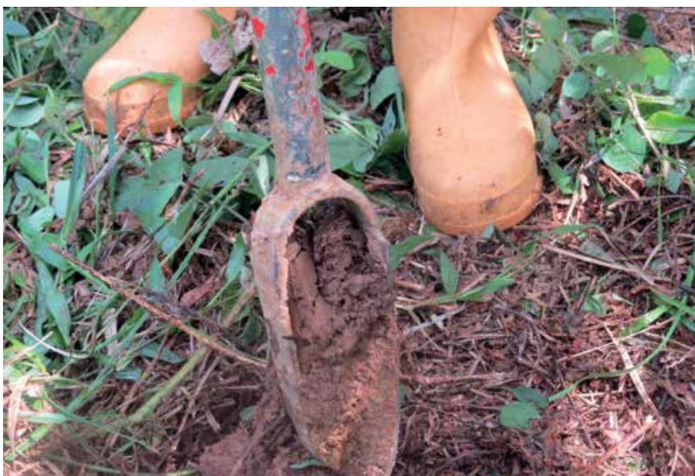
Figura 11. Retiro del barreno con muestra de suelo.
