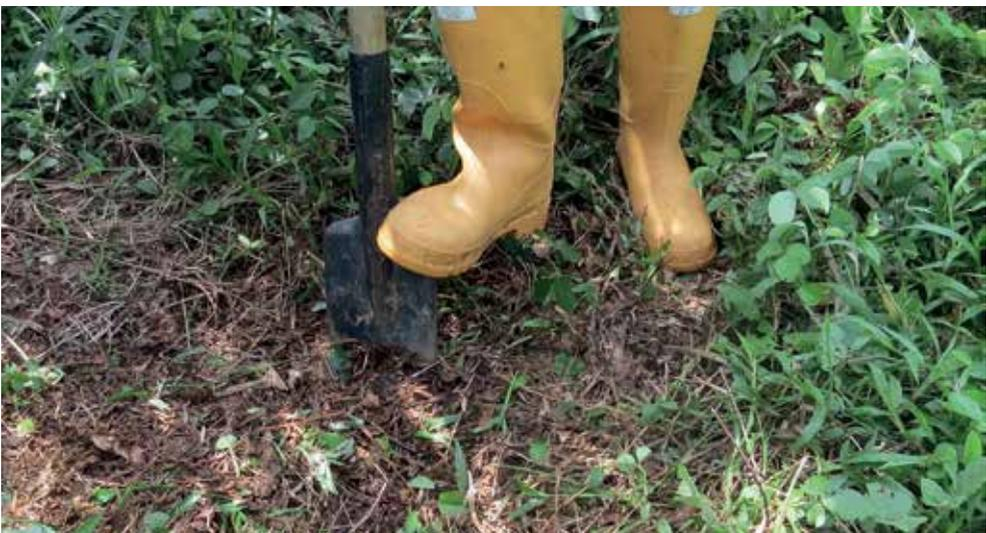
Figura 13. Perforación con palín para muestreo de suelos.
