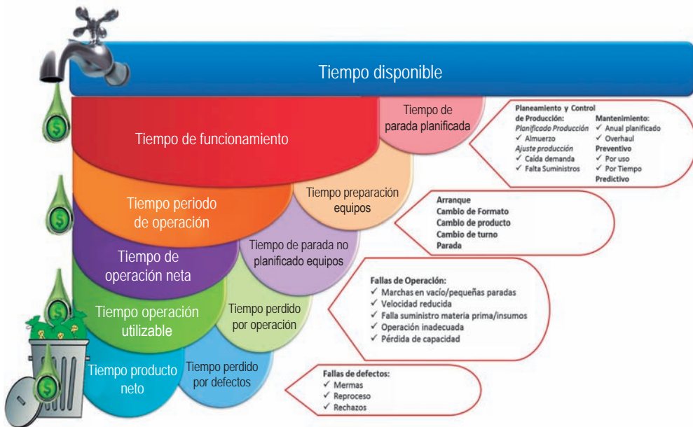
Figura 2. Esquema de composición de tiempos de acuerdo con las pérdidas. Fuente: Área de Ingeniería, Programa de Procesamiento de Cenipalma.
