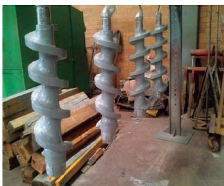
**Figura 43.** Secado y curado de la pintura polimérica.
