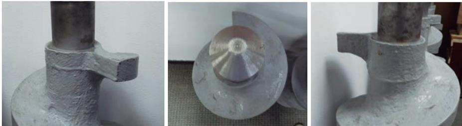
Figura 45. Detalles del tornillo recubierto con pintura polimérica.
