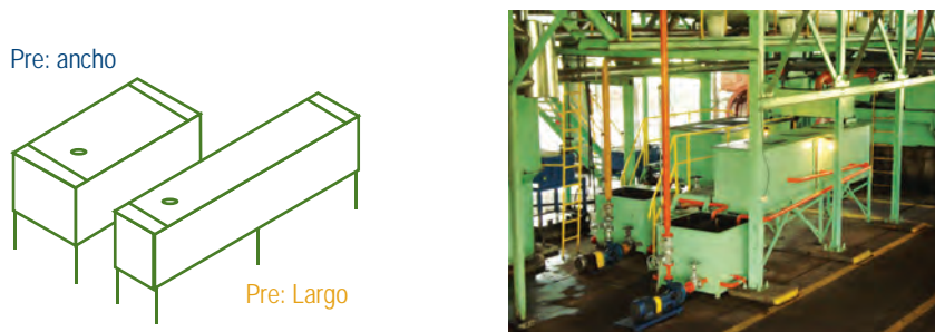
Figura 5. Preclarificadores piloto evaluados Izquierda: (l : a = 2 : 1); Derecha: (l : a = 5 : 1), Planta de beneficio Aceites Manuelita S.A.
